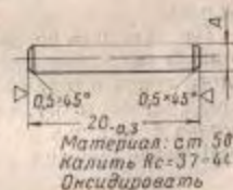
Рис. 34. Ось спускового крючка и спускового рычага
