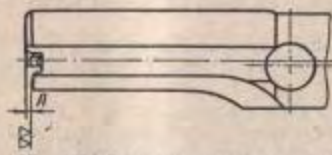
Рис. 150. Зачистка переднего среза досылателя
