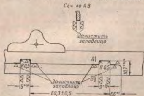
Рис. 39. Обработка стенок вырезов для предохранителя
