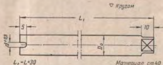
Рис. 177. Оправка для навивки пружины вручную
