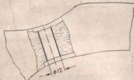
Рис. 85. Рассверловка отверстия в ложе для пробки
